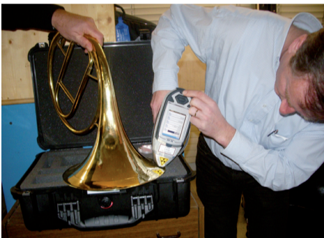
Materialanalyse eines Horns mittels Röntgenfluoreszenz XRF der Eidgenössischen Materialprüfungs- und Forschungsanstalt, Dübendorf. Nachweis: Adrian v. Steiger
