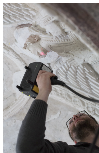
Scannen des Engelkopfes mit dem handgeführten Laserscanner der Firma Steinbichler Optotechnik GmbH, Neubeuern (Uni Bamberg). (Bild Thomas Splett)
