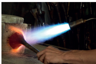
Im historischen Instrumentenbau, wie er in der Firma Egger gepflegt wird, werden die Schallstücke gehämmert und dazwischen immer wieder ausgeglüht. (Bilder: Sarah Müller)
