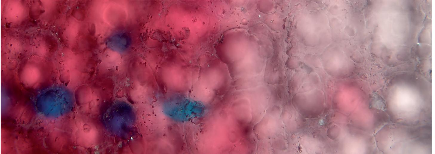
Versiegelte matte Aluminiumoberfläche eines im digitalen Untereloxaldruck gedruckten Magenta-Feldes an der Kante zum unbedruckten Aluminium. (Sebastian Dobrusskin 2022 auf Zeiss Standard Universal mit Epiplan 40 HD, Auflicht Helffeld, EDF11)
