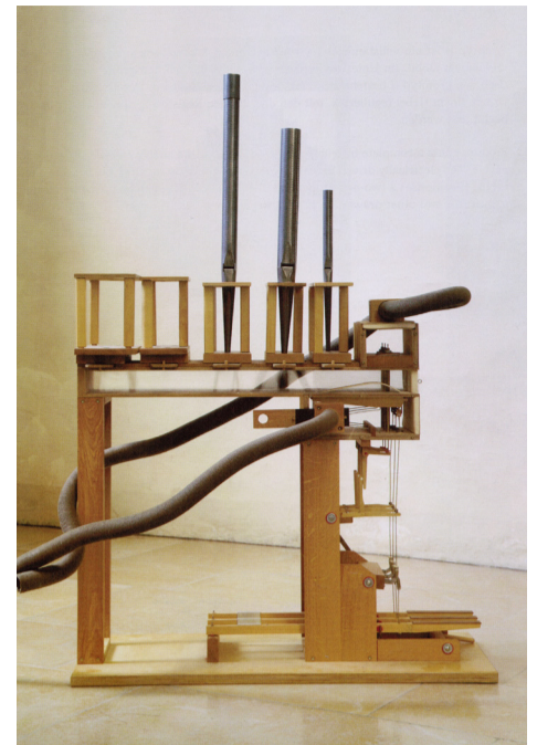
Prototyp 1 einer winddynamischen Orgel: drei Töne (Tasten), fünf Register und doppelte Windführung. Letztere erlaubt es, die Orgel mittels Tastendruck unterschiedlich laut zu spielen. (Bild: Dominique Uldry)
