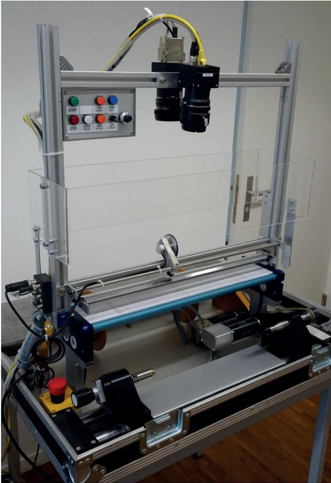
Von HKB und BFH-TI entwickeltes Werkzeug zur Digitalisierung – der Rollenscanner. (Bild: Daniel Allenbach)
