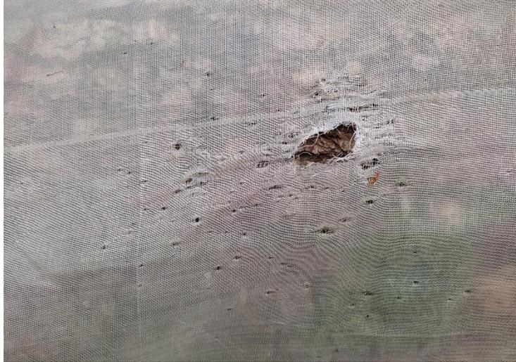
Abbildung 21: Festgestellte Schäden an einem der verwendeten Netze
