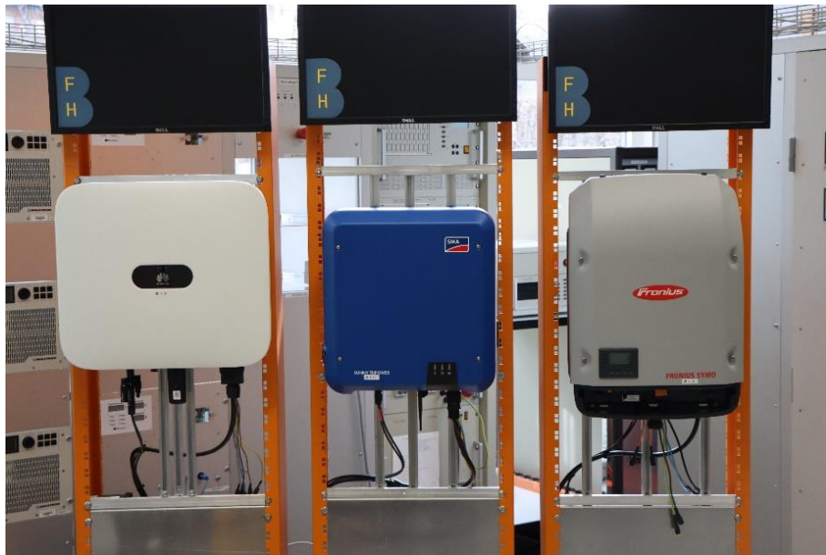
Abbildung 5.2-1 Verwendete Wechselrichter im Labortest
