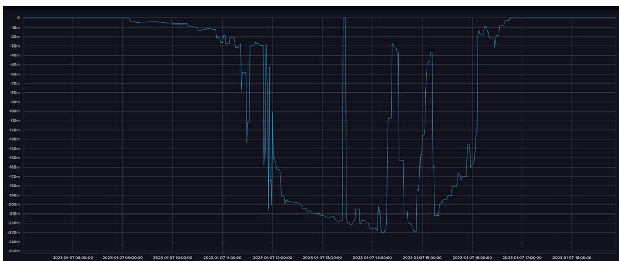
Abbildung 3 Beispielhafte Darstellung eines WR-Aussetzers um zirka 13:25 Uhr. Bei 3 der 7 getesteten Wechselrichtern war dieses Verhalten erkennbar.
