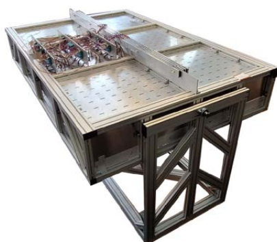
LED-Sonnensimulators mit einem aufgebauten und verkabelten LED-Element
