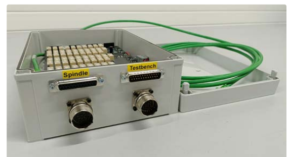
Smarte Anschlussbox mit variablem Anschluss für die Spindel und einem festen (sortierten) Anschluss für den Prüfstand
