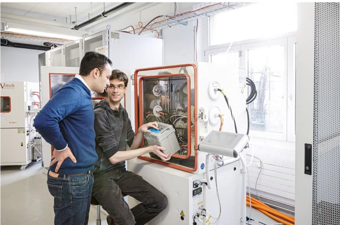
Die experimentelle Charakterisierung von Speichern dient als Basis für die Entwicklung von Batteriesystemen für Heimspeicher und die Elektromobilität.
