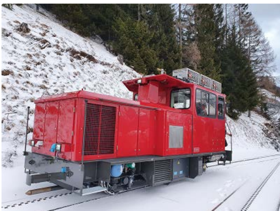
Tailor-Made Lokomotive mit Abt-Zahnstange
