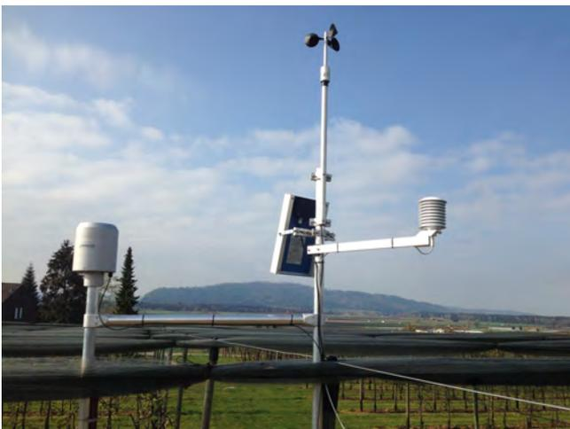
Abbildung 2: Installierte Wetterstation in Ins
