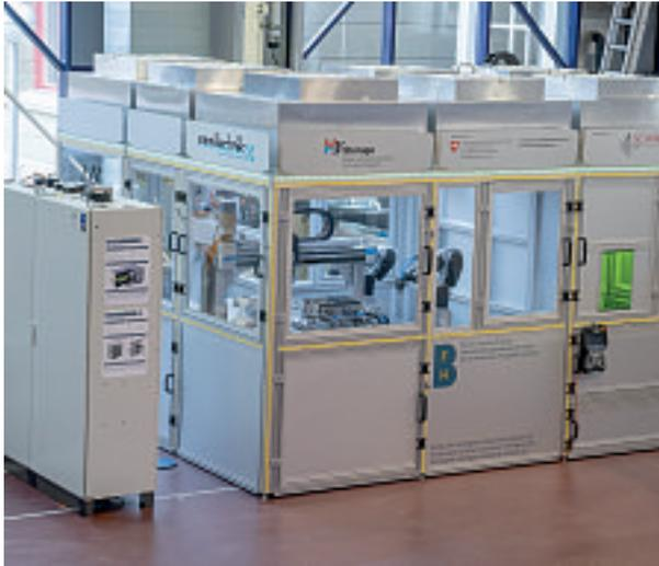
**Automatisierte Pilotanlage zur Montage von Lithium-Ionen-Batteriezellen mit Laserschneideinheit und Stapelmodul.**
