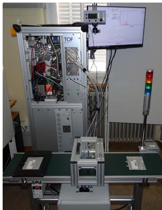
Abb. 1: komplette Messanlage (Messeinheit mit TOF-MS)
