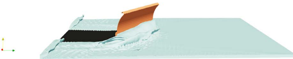
2-Phase Simulation der Variante II - 2s30b [50 mm Schneehöhe, 1300 mm Räumbreite, v = 7 km/h]
