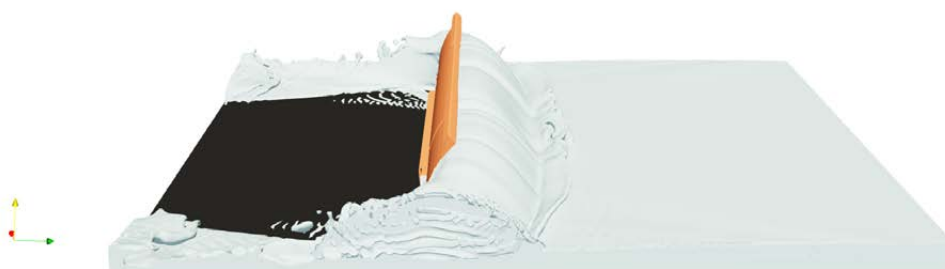
2-Phase Simulation der Variante I - 1s50B [150 mm Schneehöhe, 2650 mm Räumbreite, v = 7 km/h]
