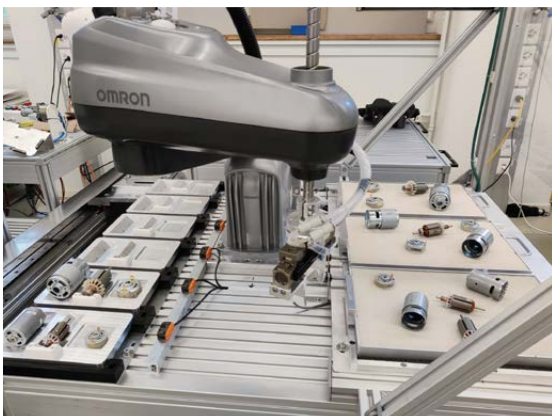
Aufbau AT1: Werkstückträger, Materialzuführung und SCARA-Roboter
