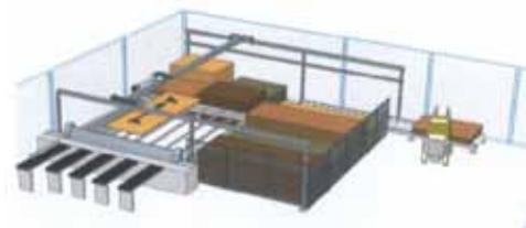
Abbildung 3: Zuschnittcenter mit Flächenlager
