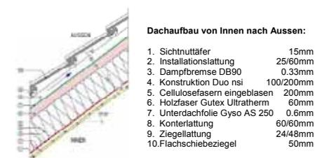
Abbildung 4 Dachaufbau Variante 1
