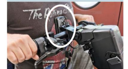
▲ Figure 2 – Ecran d'affichage sur le guidon du E-Pilot, pouvant entrer en contact avec le buste en cas de choc.
