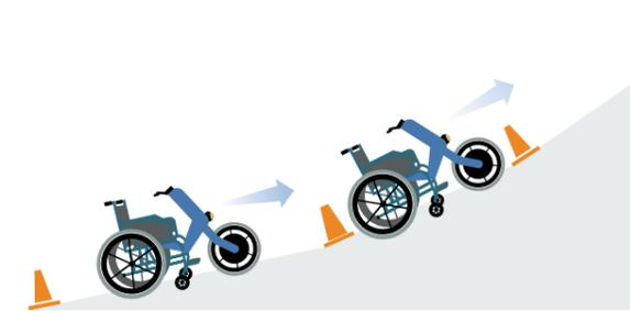
▲ Figure 11 - Sur une pente où l'inclinaison croissante est connue, on marque différents secteurs de démarrage par des cônes de signalisation. En partant du secteur avec l'inclinaison la plus faible, le véhicule est mis en mouvement depuis l'arrêt. S'il est capable de se mettre en mouvement et d'avancer depuis ce secteur, un nouveau test est mené à un secteur où l'inclinaison du sol est supérieure.
