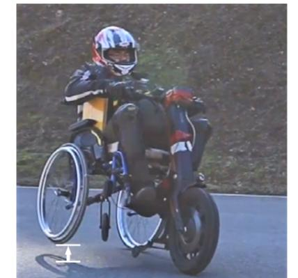
▲ Figure 1 – Soulèvement de la roue arrière, suite à une accélération transversale trop importante.
