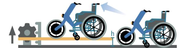
▲ Figure 7 – Le véhicule à l'arrêt doit franchir un obstacle de hauteur donnée. La surface de la plateforme est équipée de revêtement anti-dérapant. Si le véhicule parvient à entièrement se hisser sur la plateforme, la hauteur de la plateforme est alors augmentée, et la mesure à nouveau effectuée jusqu'à trouver la hauteur où le véhicule n'est plus capable de grimper.
