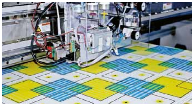
Sprühdüse mit Steuerung und Tintenversorgung montiert auf dem Versuchsdrucker.
