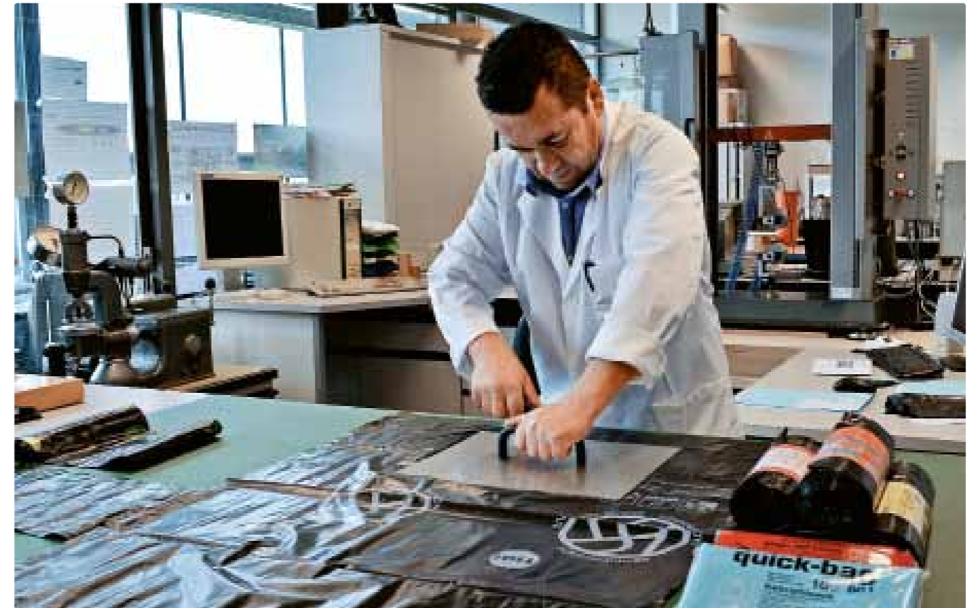
Probenzuschnitt für die Kehrriechtsackprüfung nach der OKS-Richtlinie des Schweizerischen Städteverbandes. Fotos: Ugra
