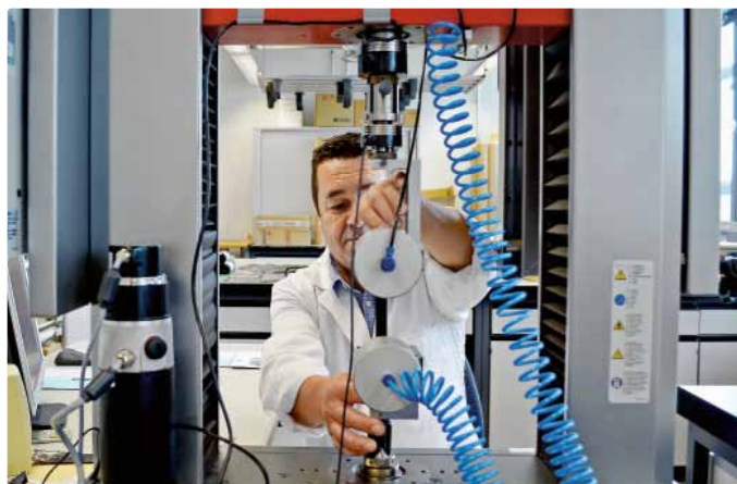
René Gross, Laborleiter Ugra, bei der Prüfung der Saumnaht am Kehrriechtsack mit der Zugmaschine.
