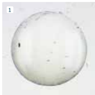
1 Links: Auf Polyesterfolie gedruckter Braillepunkt 2 Rechts: Querschnitt des Braillepunkts
