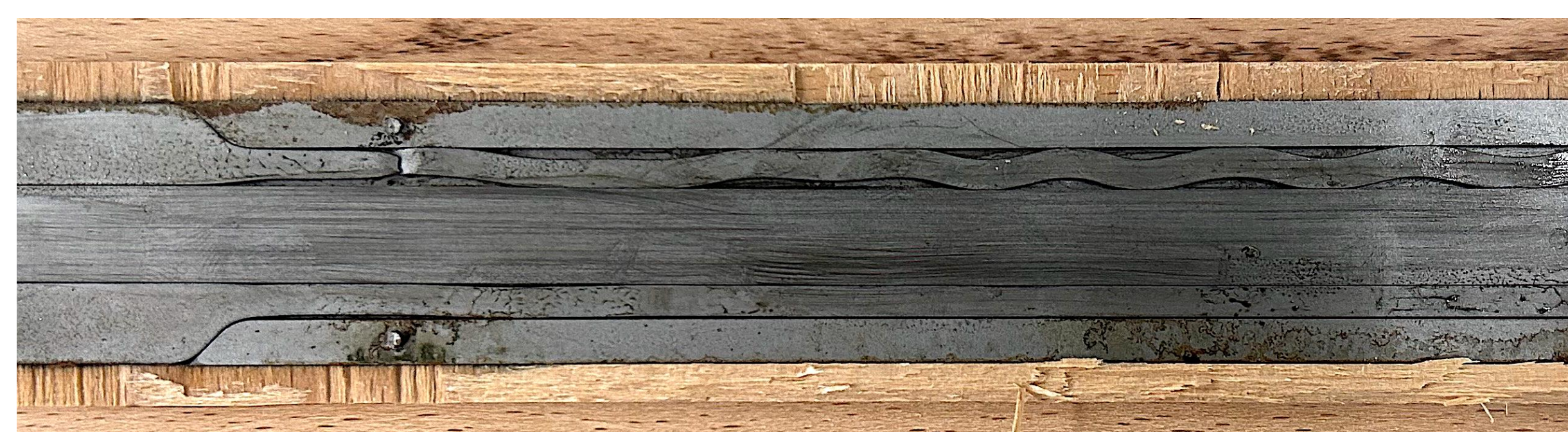
Abbildung 4: Systemzustand nach Versagen auf Zug und erneuter Druckbelastung. Der zuvor gedehnte Stahlkern nimmt bei erneutem Zusammendrücken eine typische Wellenform (Knickform) an. Das Ausknicken wird dabei durch die umliegenden Stahl- und Holzteile verhindert.
