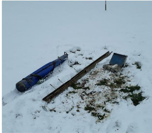
Abbildung 4: Links, 100 ml Zylinder mit organischem Boden. Rechts, Bohrung ausgelegt in Känel
