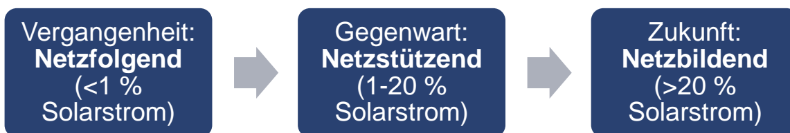
Abbildung 1: Stufen der Netzintegration von PV-Anlagen. Die Prozentzahlen sind indikativ und implizieren, dass bereits bei relativ wenig Solarstrom im jährlichen Energiemix (20% Energieanteil) in einem synchronen Netz die PV-Anlagen zu gewissen Zeiten die Produktion dominieren und damit Systemverantwortung übernehmen müssen.
