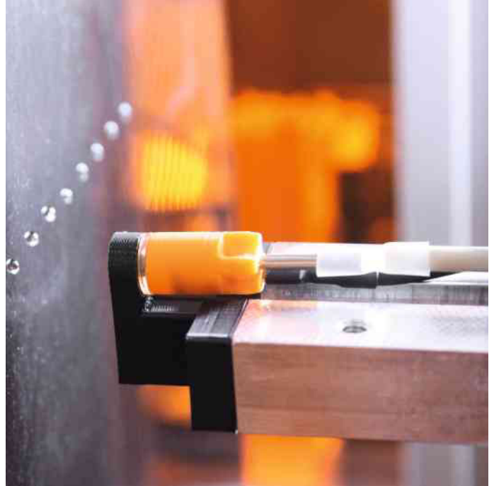
Bild 3: Dosierung mittels Mikroventil und Durchflusssensor zur Messung von Mikrolitertropfen. Bild: ReseaTech GmbH
