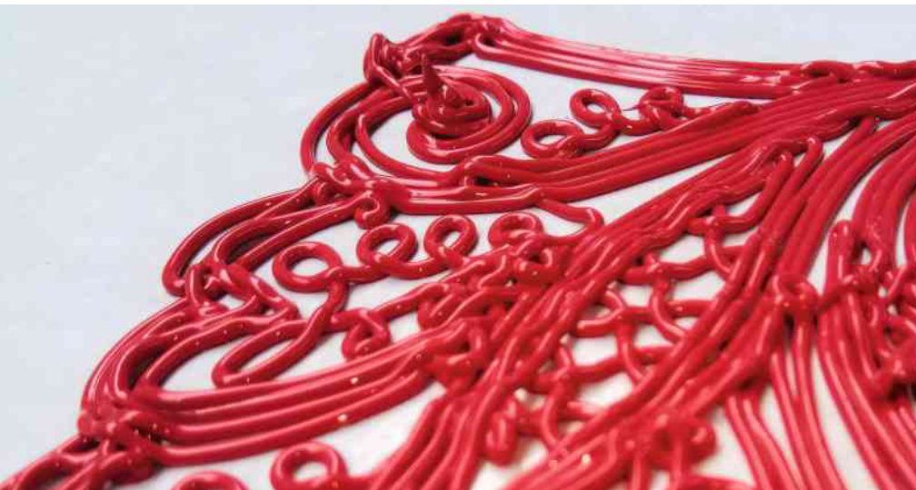
Bild 4: Gedruckte haptische Strukturen auf Textil. Bild: Berner Fachhochschule
