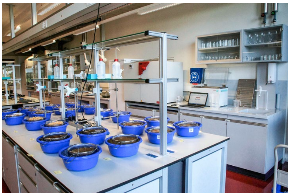
Test zur Überprüfung der Saugfähigkeit von Einstreu im Labor.
